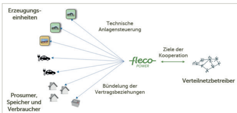
Abbildung: System zur Steuerung der dezentralen Flexibilität
